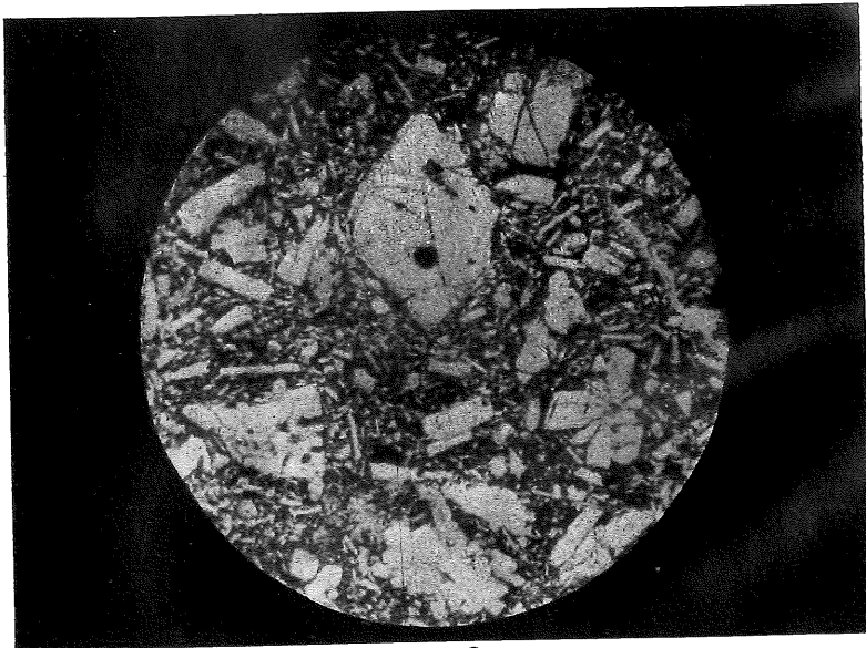
8. Basalto plagioclásico. Canteras de Santa Margarita, Amer (Gerona). L. ord. 30 d. Fenocristales de augita y olivino; microlitos de labrador y granos de augita, olivino y magnetita.
