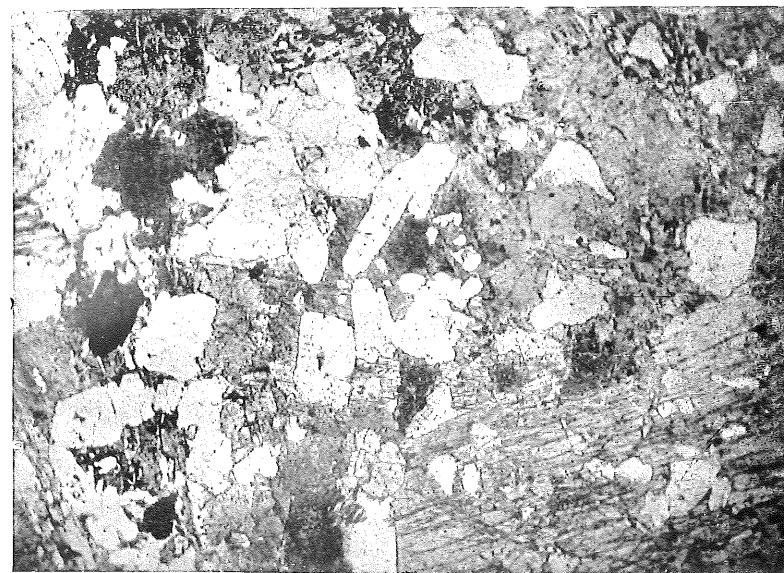
1. Diorita anfibólica. Susqueda (Gerona). L. ord. 15 d. Plagioclasa, hornblenda común y escasa biotita.
